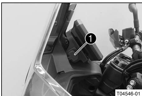
USB zdířka 1 pro napájení externích zařízení napětím je umístěna na levé straně držáku masky.
