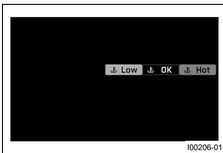
Teplota chladicí kapaliny se zobrazuje pomocí symbolu. V závislosti na teplotě se symbol mění na **LOW**, **OK** a **HOT**.
