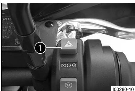
Spínač varovných světel **1** je umístěn na spínači vpravo. Varovná světla se používají k označení nouzových situací.
