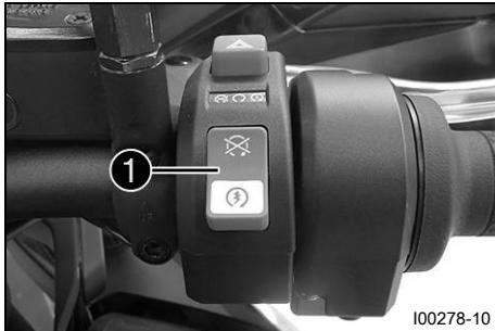
Startovací tlačítko / nouzový vypínač **1** je umístěný na kombinovaném spínači vpravo.
