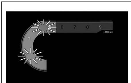
Indikátor řazení je integrovaný do ukazatele otáčkoměru resp. do displeje.
