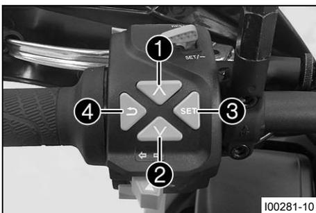
Tlačítka menu jsou umístěna uprostřed kombinovaného spínače vlevo.
