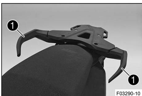
Držadla ① slouží k poježdění s motocyklem. Při provozu se spolujezdcem se ho může spolujezdec během jízdy držet.
