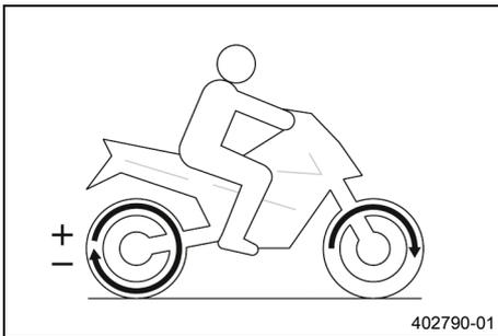
Přizpůsobení prokluzu je funkce kontroly trakce motocyklu. Přizpůsobení prokluzu umožňuje sladit kontrolu trakce motocyklu s požadovanou charakteristikou v devíti stupních.
