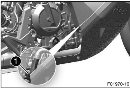
Vodním čerpadlem ① v motoru je vytvářen vynucený oběh chladicí kapaliny.
