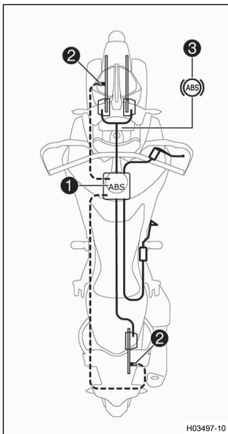
Modul ABS ① se skládá z hydraulické jednotky, řídicí jednotky ABS a zpětného čerpadla, a je namontovaný pod palivovou nádrží. U předního a zadního kola je vždy jeden snímač otáček kola ②.
