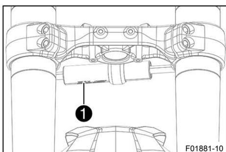
Výrobní číslo tlumiče řízení ❶ je vyraženo na spodní straně tlumiče řízení.
