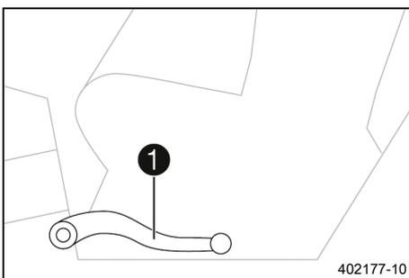
Nožní brzda ❶ se nachází před pravou stupačkou. Pedálem nožní brzdy se ovládá brzda zadního kola.
