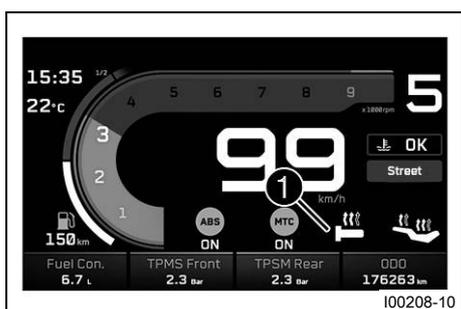
Stav vyhřívání rukojetí se zobrazuje na displeji v oblasti **1**. Vyhřívání rukojetí lze konfigurovat v menu **Heated Grip**.
