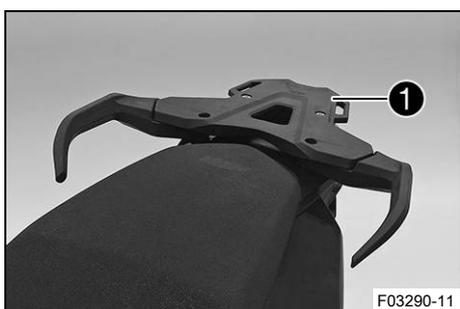
Nosič zavazadel ① se nachází za sedačkou. Na nosič zavazadel lze připevnit základní desku kufrového systému (doplňkové vybavení). Nosič zavazadel se smí maximálně zatížit uvedenou hmotností.
