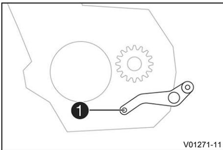
Řadicí páka ❶ je namontovaná na motoru vlevo.
