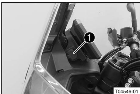
USB zdířka ❶ pro napájení externích zařízení napětím je umístěna na levé straně držáku masky.
