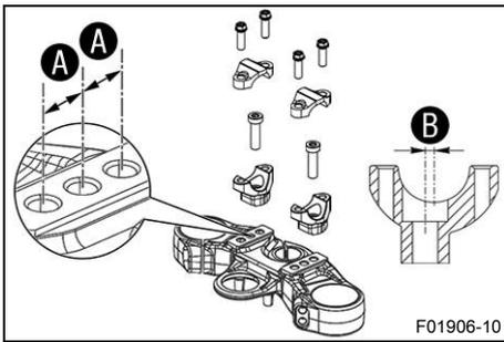
Na horní svorce vidlice jsou ve vzdálenosti **A** od sebe vyvrtané tři otvory.
