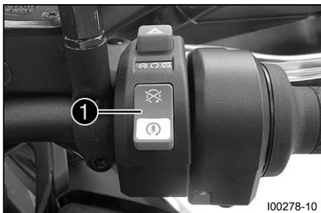
Startovací tlačítko / nouzový vypínač ① je umístěný na kombinovaném spínači vpravo.
