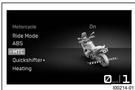
Kontrola trakce motocyklu (**MTC**) snižuje točivý moment motoru při ztrátě trakce zadního kola. V závislosti na jízdním režimu (str. 150) jsou při aktivované kontrole trakce připustné různé úrovně prokluzu.
