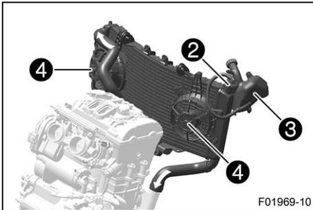
Chlazení se provádí vzduchem při jízdě a dvěma ventilátory chladiče ④, které se připojují při vysoké teplotě.
