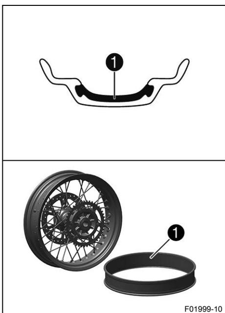
U tohoto vozidla je použitý systém bezdušových pneumatik, u něhož původní duši nahrazuje bezdušový těsnicí kroužek ①. Výhody bezdušového systému jsou v tom, že neexistuje riziko poškození duše. Velmi je přitom sníženo riziko prudké ztráty tlaku.
