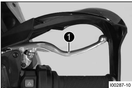
Páčka ruční brzdy ❶ je umístěna na řídítkách vpravo. Páčkou ruční brzdy se ovládá brzda předního kola.
