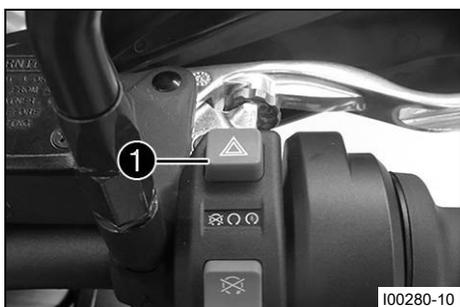
Spínač varovných světel ① je umístěn na spínači vpravo. Varovná světla se používají k označení nouzových situací.
