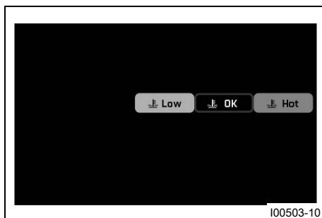
Teplota chladicí kapaliny se zobrazuje pomocí symbolu. V závislosti na teplotě se symbol mění na **LOW**, **OK** a **HOT**.
